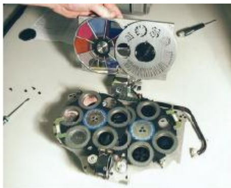
Рисунок 26. Открытие модуля проекции
