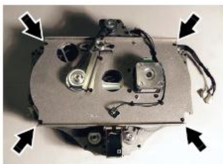
Рисунок 26. Открытие модуля проекции
